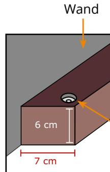
**WICHTIG:** wenn abgeschnitten wird, zusätzliche Bohrung und Senkung setzen!
