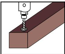
Durch die Vorbohrung bohren
