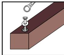
Schraube und Unterlegscheibe einschrauben
